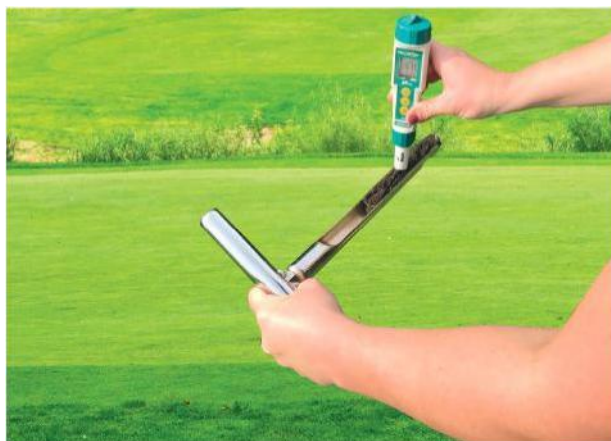
SoilStik illustré utilisé avec l'échantillonneur de sol modèle 6510 HC (disponible en ligne)
