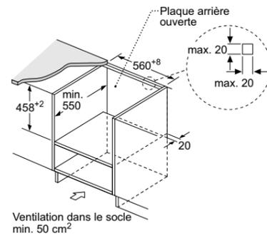
Ventilation dans le socle min. 50 cm<sup>2</sup>
