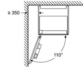
En cas d'utilisation du limiteur de charnière à 92°, la distance min. au mur est uniquement de 100 mm
