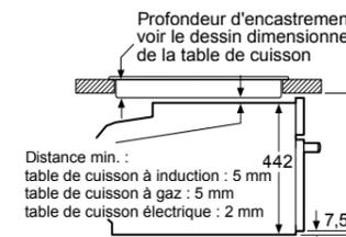
Si l'appareil compact est installé sous une table de cuisson, les épaisseurs de plaque de travail suivantes (le cas échéant y compris la sous-structure) doivent être respectées.
