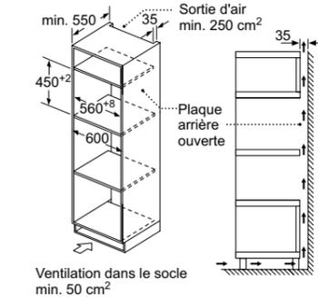
Ventilation dans le socle min. 50 cm<sup>2</sup>
