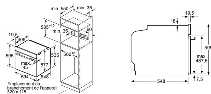
Emplacement du branchement de l'appareil 320 x 115
